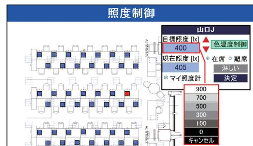
Fig. 1 知的照明システムのユーザインターフェース
