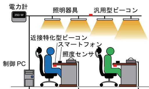
Fig.2 ビーコン型知的照明システムの構成
