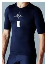
Fig.1 ウェアラブル心電センサ (hitoe)
