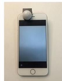
Fig.4 照度推定用携帯端末
