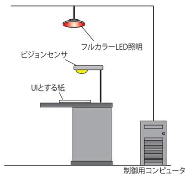
Fig.1 CICS/CPUI のシステム構成図
