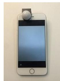
Fig.4 照度推定用携帯端末
