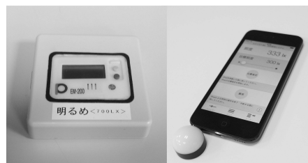
Fig.2 変更前（左）および変更後（右）の照度センサ
