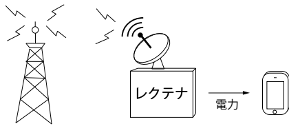
Fig.4 電波発電の原理
