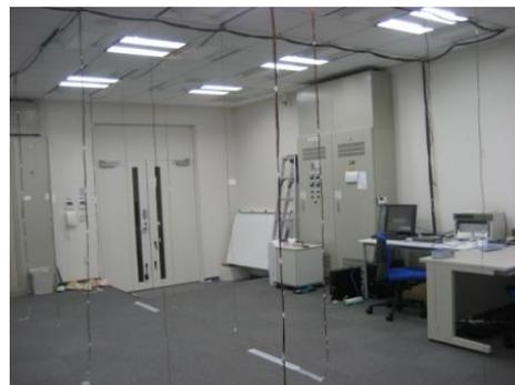
Fig.5 熱電対の設置した様子
