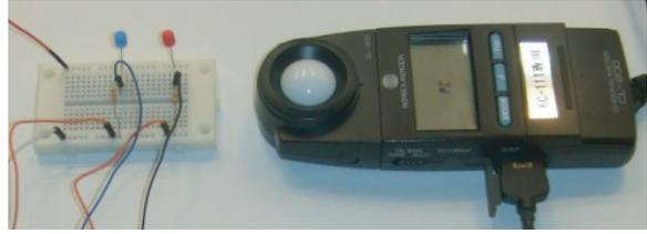
Fig.5 実験環境 (左:NaPiCa 色温度センサ 右:色彩照度センサ)
