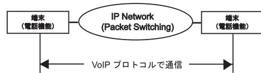
Fig. 1 VoIP の原理的な構成
