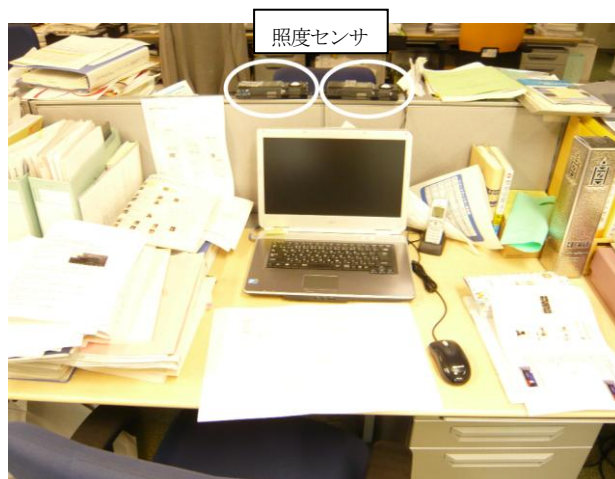
図1：照度センサが机上面に設置できない状況
