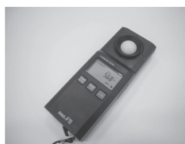
図5 コクヨ株式会社で用いた照度センサ Fig.5 The sensor used in the office of Kokuyo Co., Ltd.
