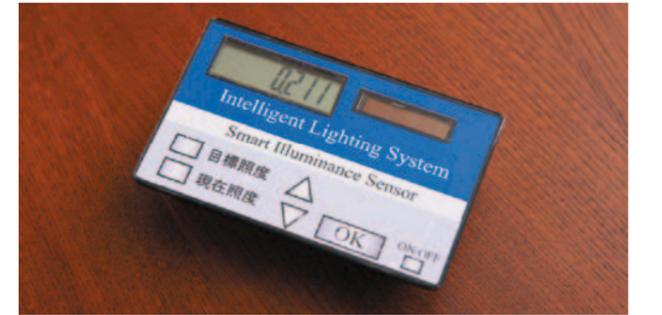
このシステムの特徴は、照明機器の一つひとつにマイクロプロセッサを搭載し、自律して明るさを制御できる点にあります。さらに照度を測るカード型のセンサーをユーザーのところに置き、そこで指定された「希望の明るさ」の情報を無線ネットワークで照明に伝えることで最適化を実現します。
