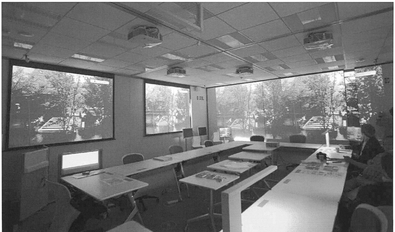
擬似窓に建物の外の景色をハイビジョンカメラで表示する実験。本物の景色と見間違えくらいリアルに映しだしている。
